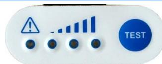
Wenn die Test-Taste am Ende des Ladevorgangs gedrückt wird, nachdem die externe Stromquelle entfernt wurde, zeigen die LEDs den Ladezustand des Akkus zu diesem Zeitpunkt an. Die folgende Tabelle zeigt den Ladezustand des Akkus anhand der Anzahl der leuchtenden grünen LEDs.
