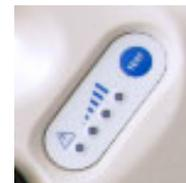
充電終了後、外部電源を切断した後にテストボタンを押すと、その時点での電池残量がLEDに表示されます。下表は、緑のLEDの点灯数に基づいた電池残量をまとめたものです。
